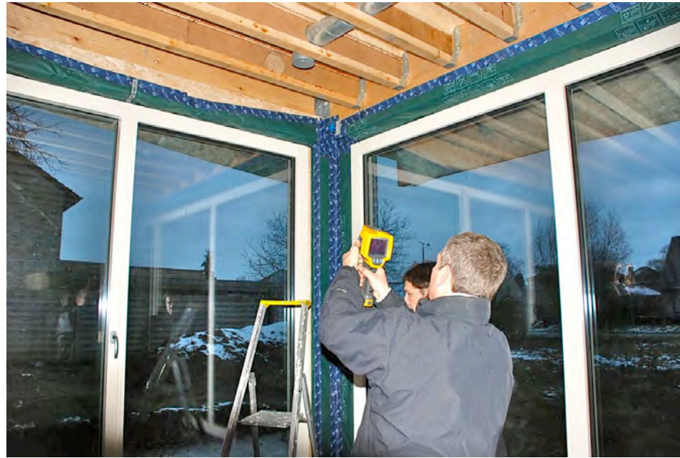
Lekken en kieren werden opgespoord met een infraroodcamera
